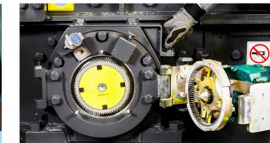
Patentierte Rotorverriegelungs- und Positioniereinrichtung für mehr Sicherheit
