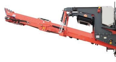
Hydraulisches Anheben und Absenken auf den Hauptförderer
