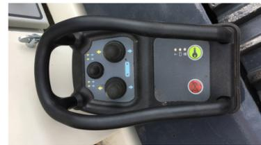
Eine Fahrwerk-Fernsteuerung für kabellosen und kabelgebundenen Betrieb
