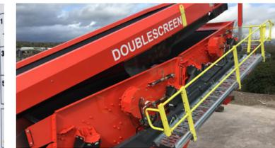
Hydraulisch klappbare Wartungsplattformen für leichte Wartung
