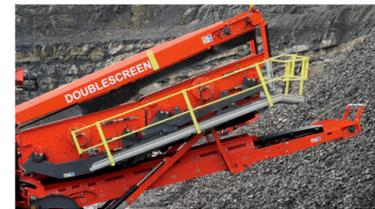
Dreifachdeck-Doppelsieb mit unabhängiger Winkeleinstellung und zum Patent angemeldeter hydraulischer Siebtrennung
