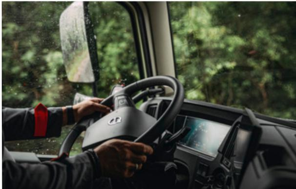
**5 INSTRUMENTENANZEIGE.** Ein vollständig digitales Kombiinstrument, das auf Ihren Lkw, Ihre Bedürfnisse und die Fahranforderungen abgestimmt ist. Sie steuern die Differenzialsperren und die Last auf jeder Achse. Für eine bessere Traktion drehen Sie den Schalter für die Differenzialsperre einfach im Uhrzeigersinn. Über das zusätzliche Display steuern Sie die Kommunikationsgeräte.
