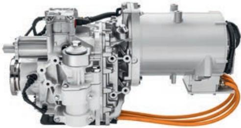
**ELEKTRISCHE ANTRIEBE.** Der Antrieb ist in zwei Varianten erhältlich. Der Antrieb des Volvo FL Electric besteht aus einem Elektromotor und einem 2-Gang-Getriebe. Dabei handelt es sich um dieselbe Lösung, die auch bei den vollelektrischen Bussen von Volvo zum Einsatz kommt. Der Antrieb des Volvo FE Electric basiert auf dem gleichen Motor, der jedoch zweimal verbaut ist.
