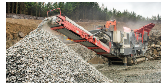
Langer Hauptförderer für massives Aufhalten
