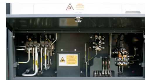
Stahlrohrleitungen für bessere Wärmeableitung
