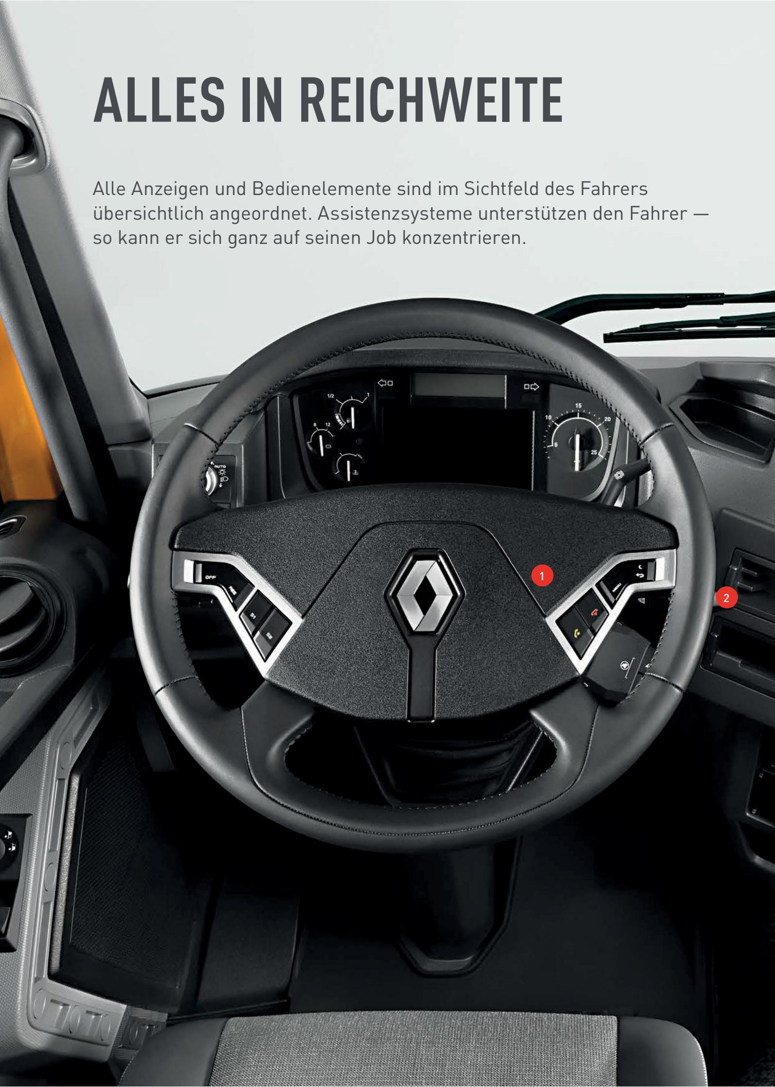
1 **BEDIENUNG AM LENKRAD FÜR TELEFON, GESCHWINDIGKEITSREGLER UND -BEGRENZER SOWIE MENÜSTEUERUNG**
