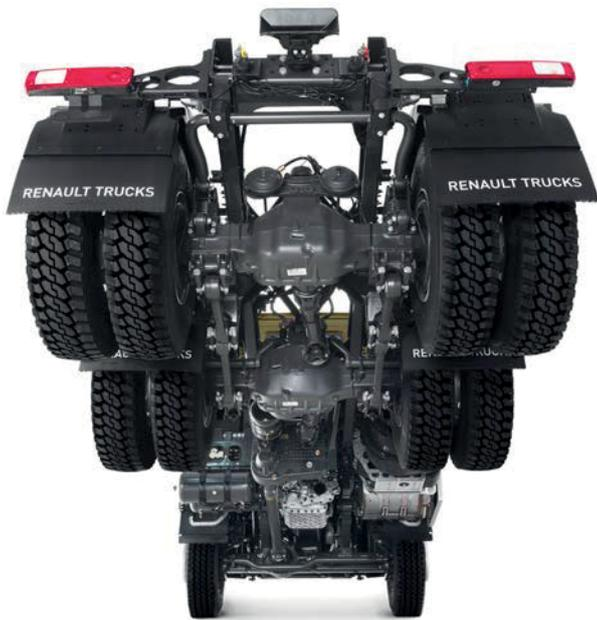
**TANDEMACHSE MIT DOPPELTER ÜBERSETZUNG**
