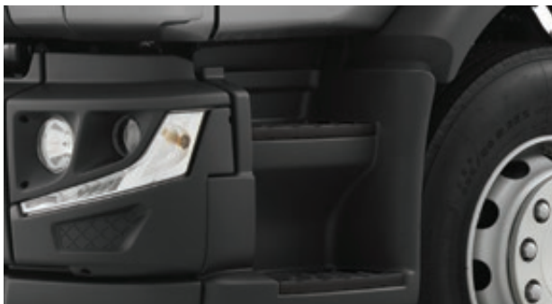
TREPPENARTIGER EINSTIEG mit 80 mm Tiefenunterschied zwischen beiden Trittstufen für den einfacheren Zugang zum Fahrerhaus.
