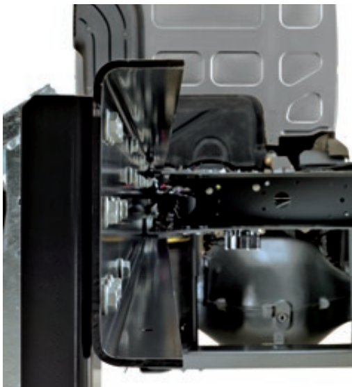
RAHMENLÄNGSTRÄGER aus hochfestem Stahl.
