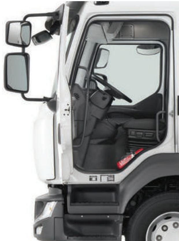
90°-ÖFFNUNGSWINKEL DER TÜREN erleichtert den Einstieg in das Fahrerhaus.
