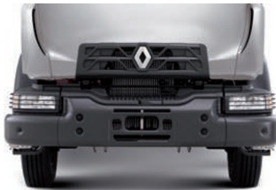
VOLLSTAHL-STOSSSTANGE (D) für schwerste Einsatzbedingungen.
