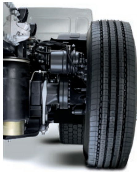
LUFTFEDERUNG HINTEN für mehr Fahrstabilität und Komfort.
